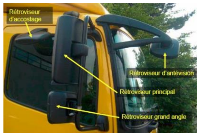
Figure 4 : Systèmes de détection des piétons et des cyclistes sur l'avant et les côtés des camions.
